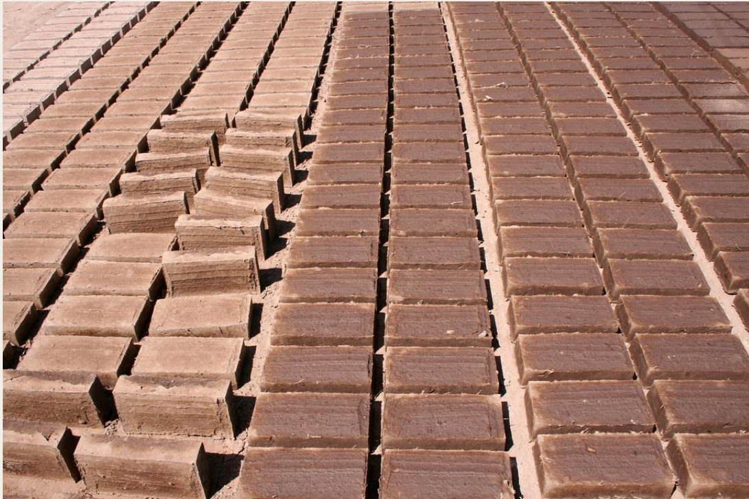
Ladrillos de adobe en proceso de secado, hechos al aire libre.
