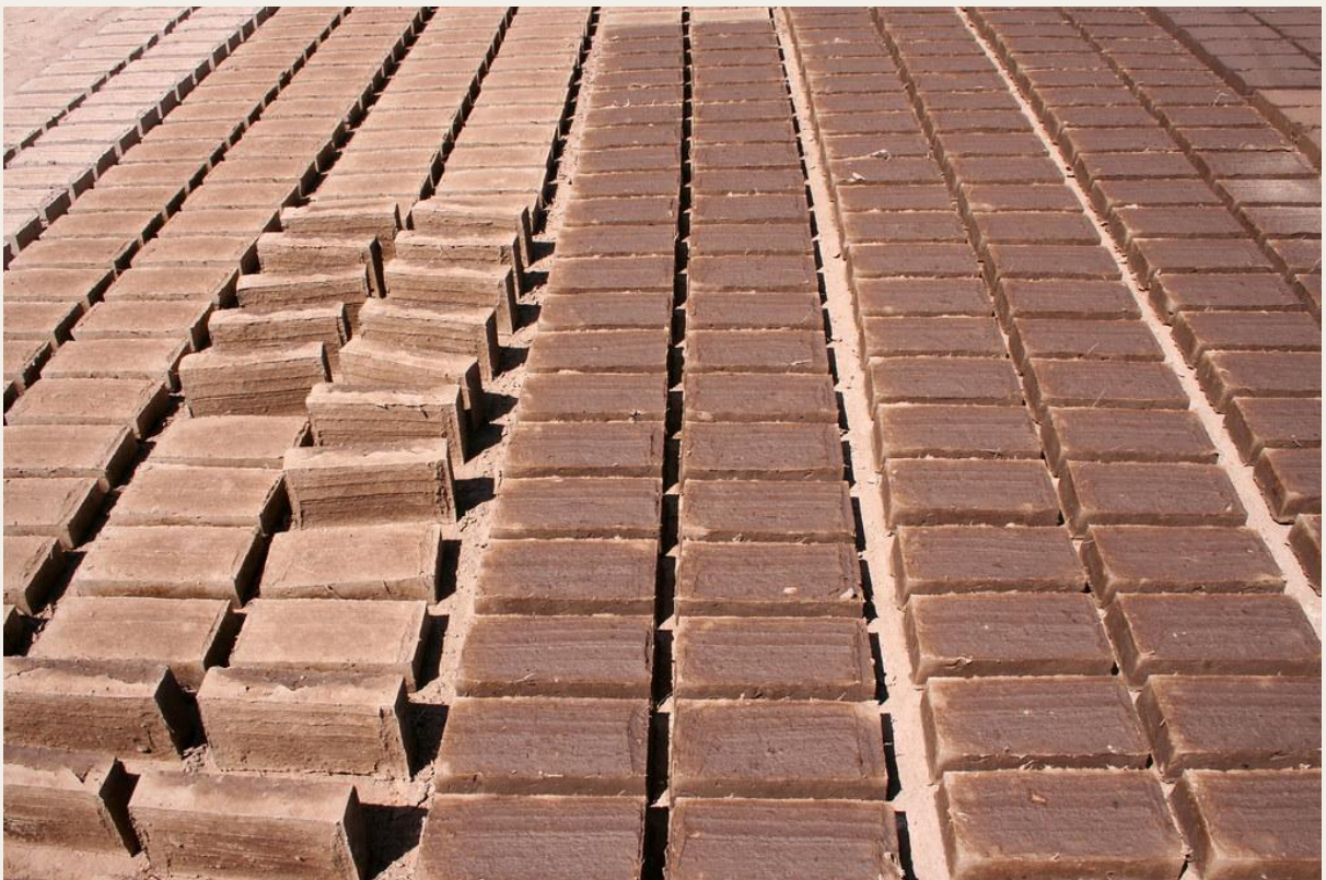
露天制成的晾晒过程中的土坯砖。
